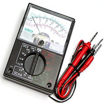
三用電表VAC 檔 量測電壓
